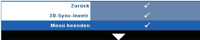
**3D-Sync-Invert**—Falls ein ungleichmäßiges oder überlappendes Bild beim Tragen der DLP-3D-Brille angezeigt wird, müssen Sie möglicherweise zur Erzielung einer optimalen Abstimmung der Links-Rechts-Bildfolge und damit der Gewährleistung einer korrekten Bildanzeig die „Invert“-Funktion ausführen. (bei DLP-3D-Brillen)
